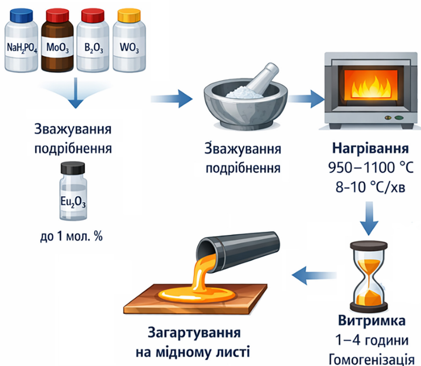
Рис. 2. Схематичне зображення одержання фосфатного скла методом швидкого охолодження розплаву
