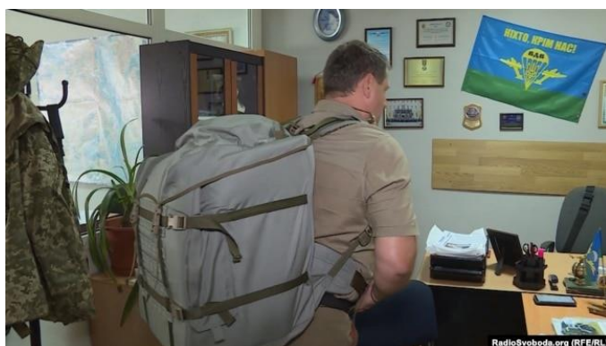
Фото. Переносний фільтр для використання в бойових умовах. Вага його – близько 28 кілограмів. Він очищає 20 літрів на годину. Головне – щоб поруч було джерело води.
