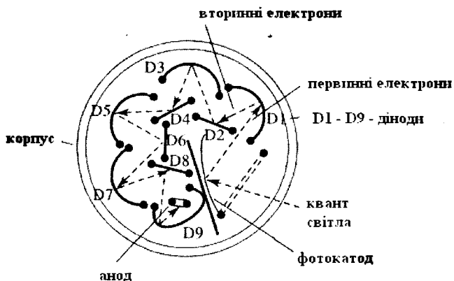
Рис. 16.5. Принцип дії ФЕП
