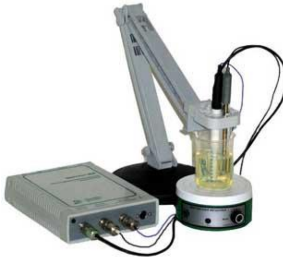
Рисунок 2.6 – Схема кондуктометричної комірки для вимірювання електропровідності води (а), сучасний кондуктометр (б).
