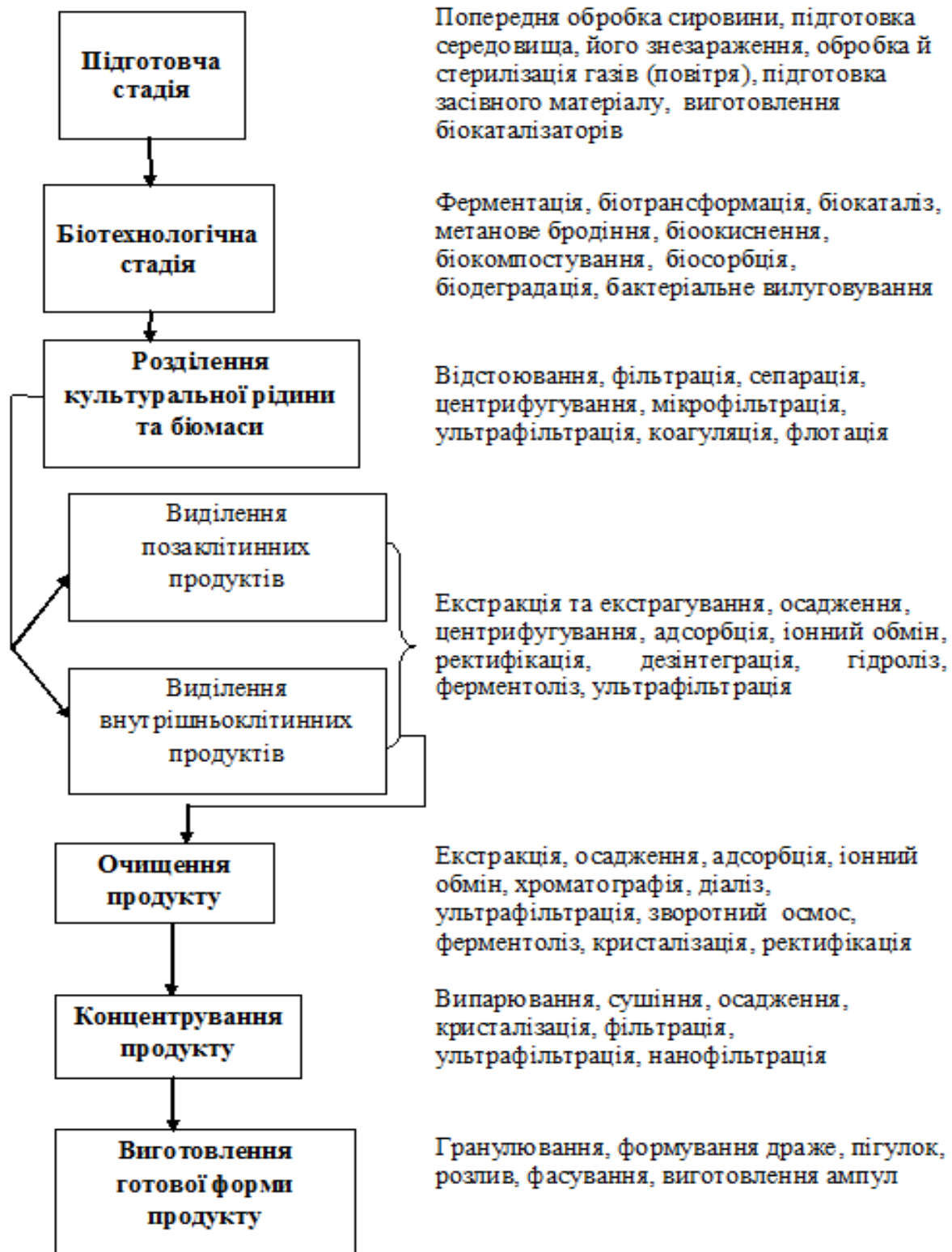
Рис. 76. Узагальнена схема стадій біотехнологічного виробництва
