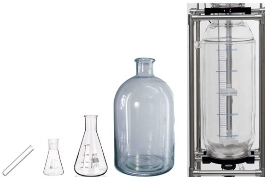
Рис. 77. Масштабування культури продуцента у біотехнологічному виробництві
