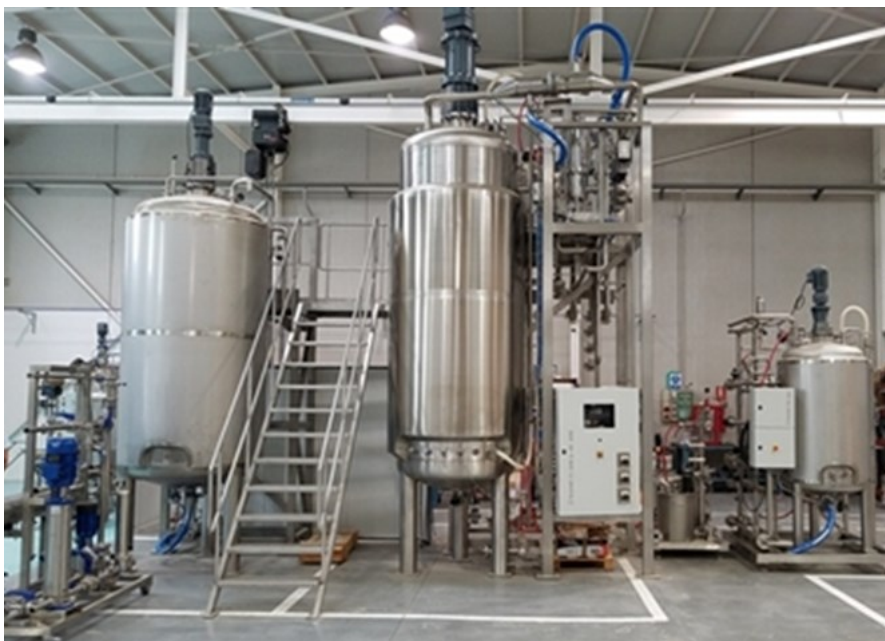
Рис. 30. Біореактори (ферментери) – це обладнання для вирощування біологічних культур у контрольованих стабільних умовах
