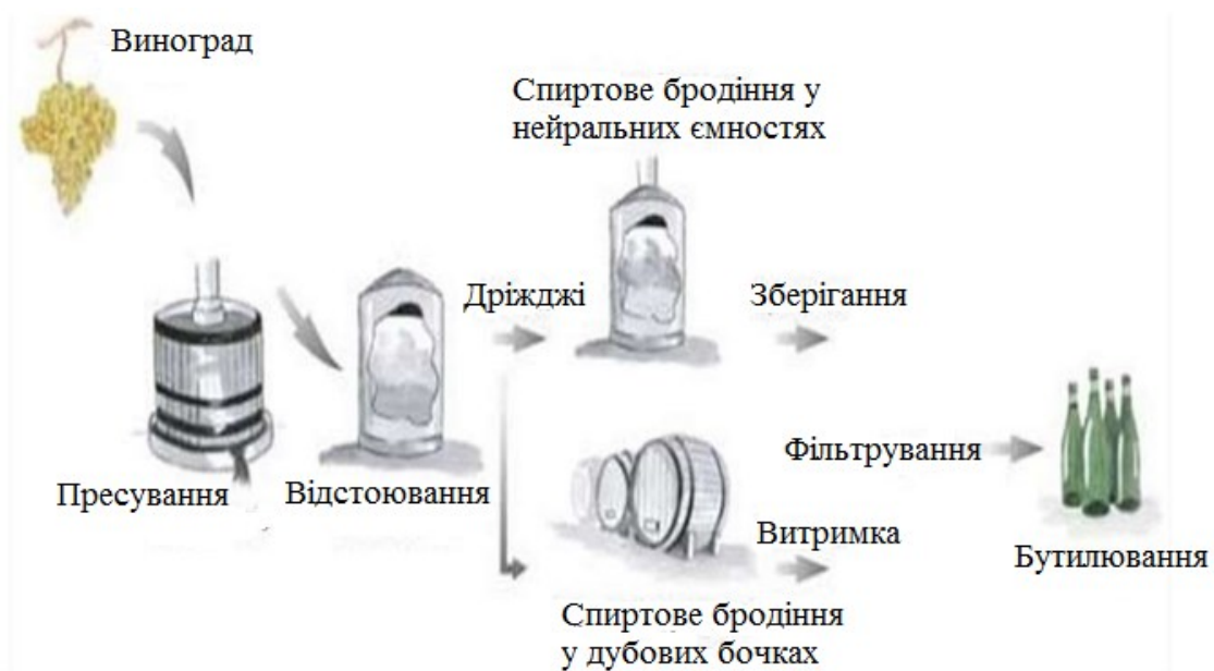
Рис. 97. Схема виробництва вина
