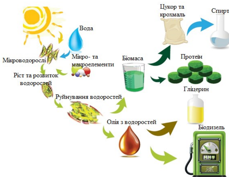
Рис. 116. Схема перетворення мікроводоростей у різноманітні види палива та продуктів
