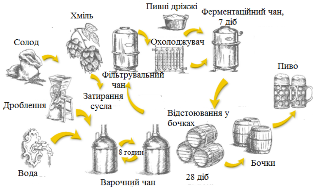
Рис. 96. Схема здійснення процесу пивоваріння
