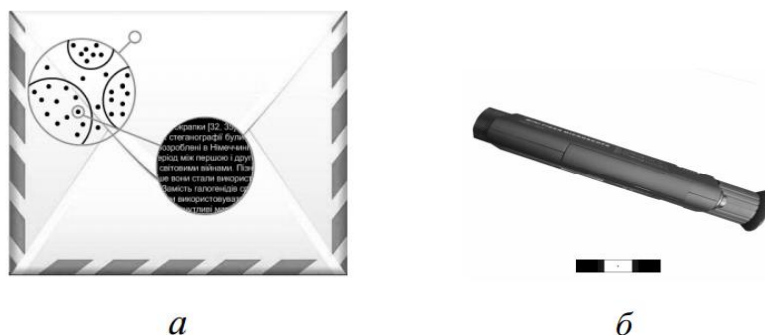
Рис. 11.5. Приклад застосування мікрокрапок у стеганографії: а) конверт з мікрокрапкою; б) спеціальний кишеньковий мікроскопом для читання мікрокрапок
