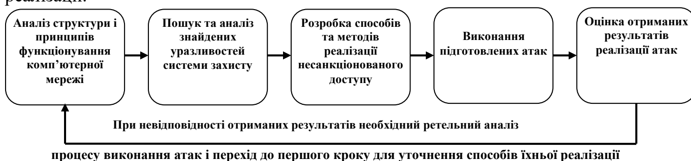
Рис. 5.1. Алгоритм підготовки і реалізації несанкціонованого доступу в сучасних АСУ
