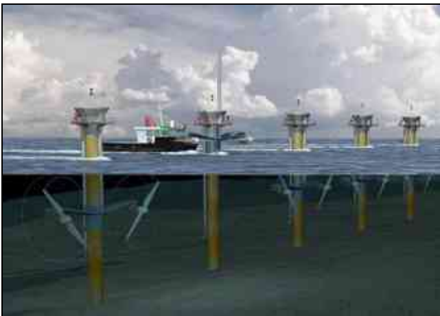
Рис. 132. Перший комерційний генератор енергії припливів SeaGen
