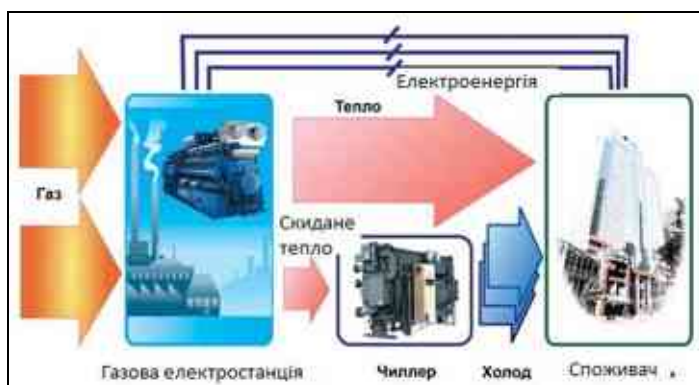
Рис. 101. Схема тригенерації з використанням абсорбційного чиллера на скиданій гарячій воді
