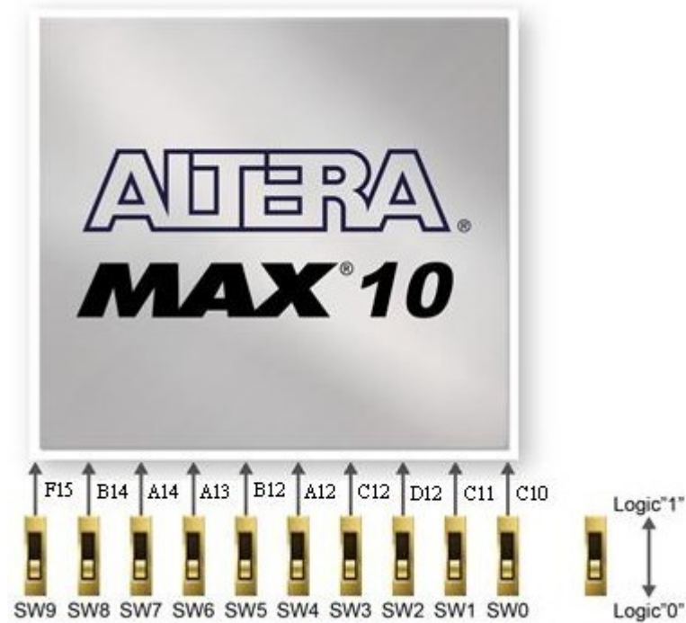
Рисунок 6.4 – Підключення між слайд-перемикачами і MAX 10 FPGA
