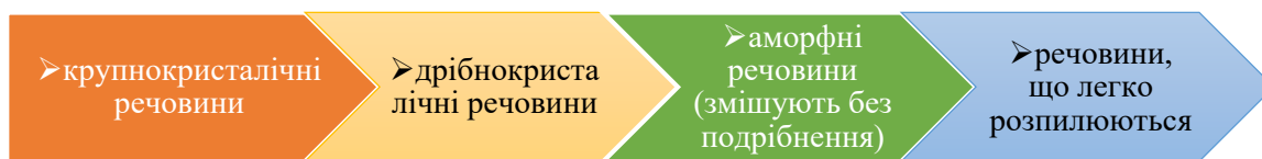
Рис. 6.3. Порядок змішування речовин при виготовленні порошків
