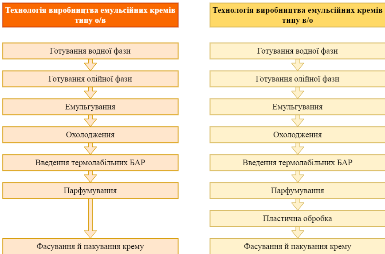
Рис. 10.8. Технологічні стадії виробництва емульсійних кремів
