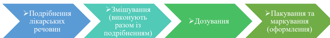
Рис. 6.2. Технологічні стадії виготовлення порошків
