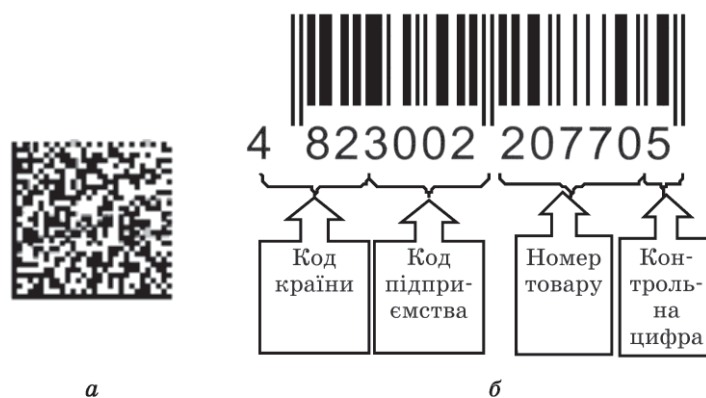
Рис. 2.14. Приклади двовірного (а) і лінійного (б) (із зазначенням структури коду EAN-13) штрих-кодів
